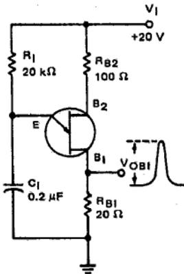
**FIGURE 4 –  $f(\text{max})$  MAXIMUM FREQUENCY TEST CIRCUIT**
