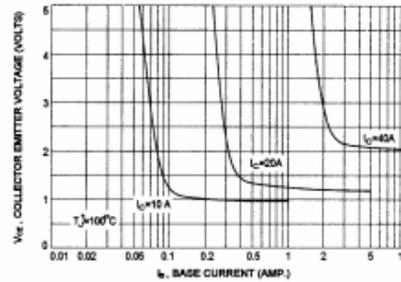
COLLECTOR EMITTER SATURATION VOLTAGE
