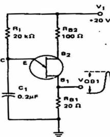
FIGURE 4 - F(max) MAXIMUM FREQUENCY TEST CIRCUIT
